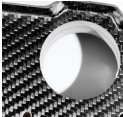
Bilder 3a (links) und 3b (rechts): Mit Spezial-KSS können Leichtbaumaterialien wie CFK qualitativ und wirtschaftlich bearbeitet werden (3a), hier im Vergleich mit herkömmlicher Trockenzerspanung (3b).
